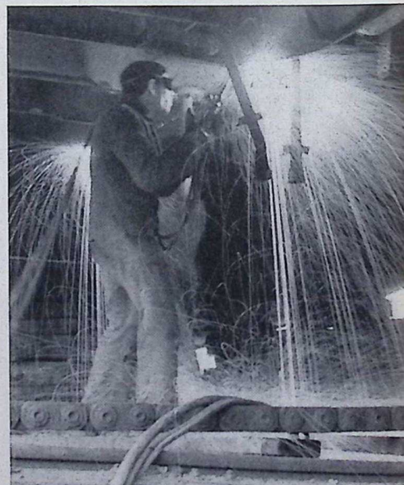
Brander R. Pico Rodriguez maakt vuurwerk bij het op maat afsnijden van de wrangen, die voor de helft vernieuwd werden.
