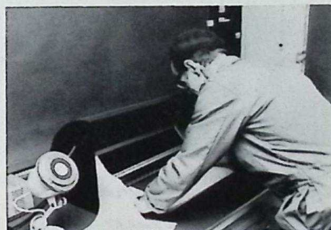
Dit is een elektrodenpers (Smit-Nijmegen). In de cilinder wordt de bekleding om de lasstaaf geperst. Met de transportband worden de geperste elektroden verder vervoerd ter droging, controle en verpakking.
