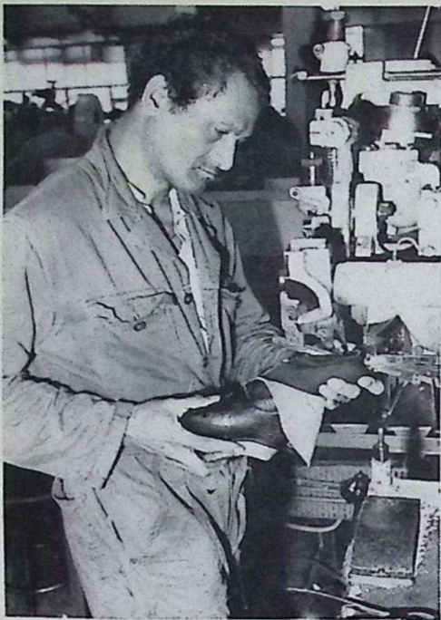
Eén van de zwikmachines, die het leer omzwikt en tegelijk vastzet.
