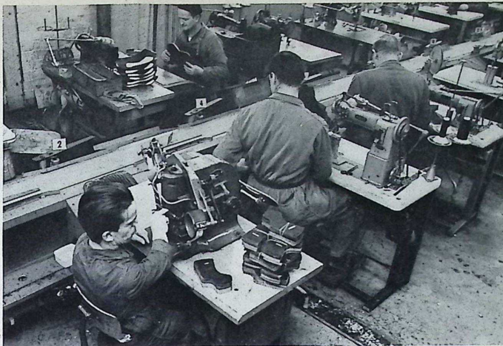
Overzicht van de stikkerij met in het midden de automatische stikkerij-band.
