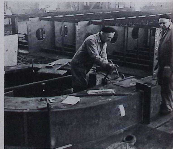
S. den Boef en C. Moed bezig met het derde binnenpomphuis voor Smit-Kinderdijk.
