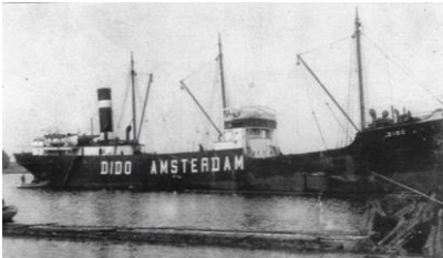
Naam s/s Dido (1), Bouwjaar 1917, Bouwnummer 561 Bouwwerf N.V. Scheepswerf Weduwe C. Boele & Zn., Slikkerveer-Nederland. Bouw tewaterlating 31 maart 1917 en 22 mei 1917 opgeleverd als “AUGUST BORREMAN”. BRT 756 NRT 327 DWT 1.025 LxBxH 58,32 x 8,59 DG 3,81 Type schip: Passagiers Vrachtschip, raised-quarterdek type, 1 dek. - Machine Triple expansie stoommachine, 3 cyl. PK 600 ipk. Mijl 9, Machinebouwer N.V. Machinefabriek Bolnes, Bolnes-Nederland
