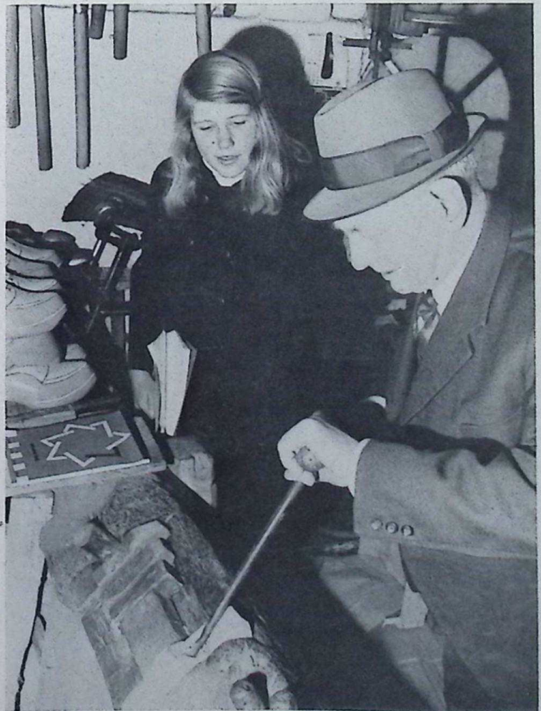
Dan wordt met een handboor de klomp uitgehold. Annemieke Boele schijnt te zeggen „aha, gaat dat zo!"
