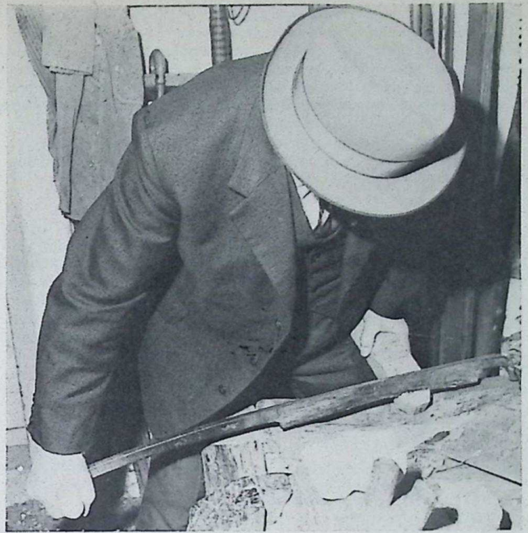
En dit is het blokmes, waarmee de fijnere vorm aan de klomp gebracht wordt.
