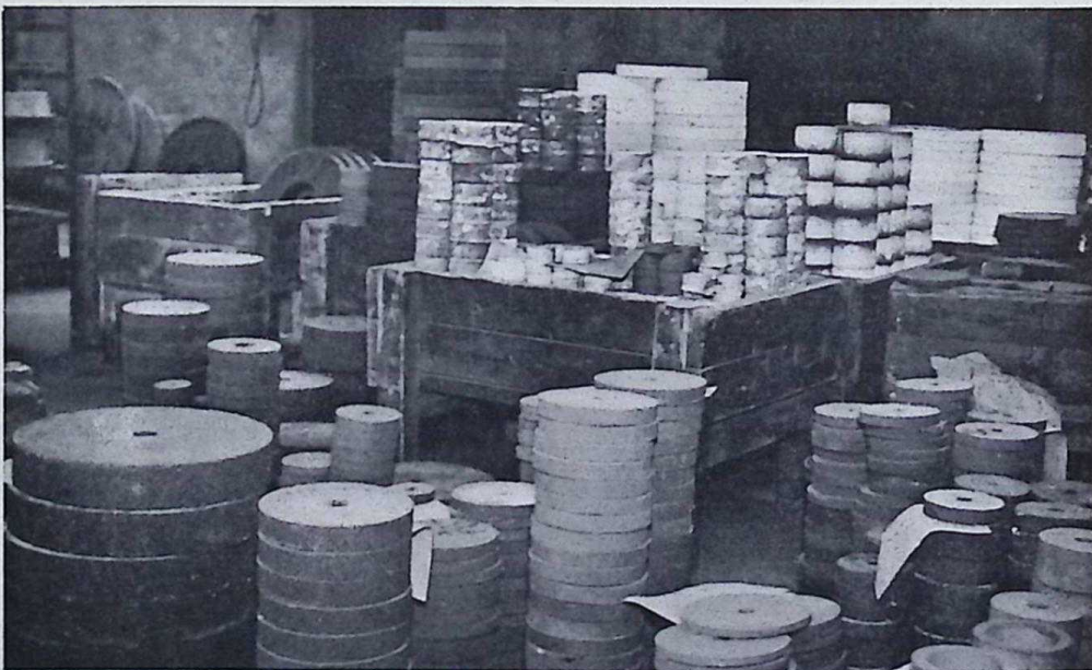
Een serie slijpschijven, vers gebakken in de keramische oven (foto Jannink & Co.).
