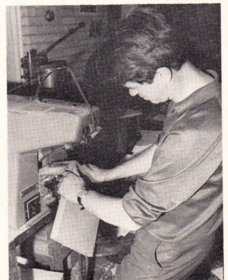
De ingesneden hoeken van de dozen worden machinaal met een bandje vastgemaakt. →
