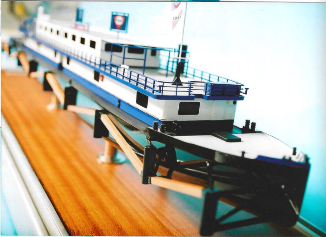
FINA 42 Bunkerstation THEUNS L. 72.94 x Br. 9.05 x D. 2.10 omgebouwd als bunkerschip bij Scheepswerf Kooiman in 1969 in gebruik t/m 2002
