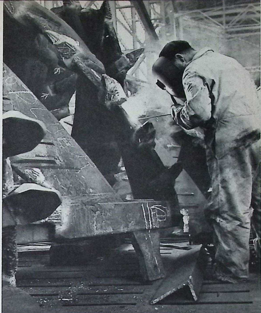
Cutters geschikt maken voor rotsbodem. De lasser is J. Verveer.
